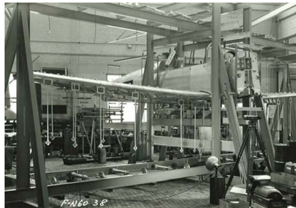
Fig. 33 Pilatus P3 test set up
